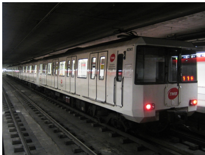
Fig. 3. Vía bibloque. Línea 1 del Ferrocarril Metropolitano de Barcelona.
